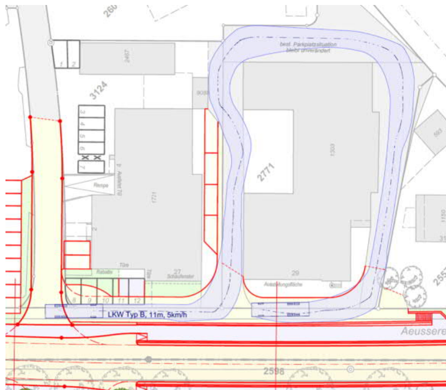
Abbildung 11: Schleppekurven LKW Typ B Umfahrung Äussere Luzernerstrasse 291 21
